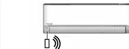
Wifi-sovitin CZ-TACG1 asennetaan pumpun sisään tai viereen.
